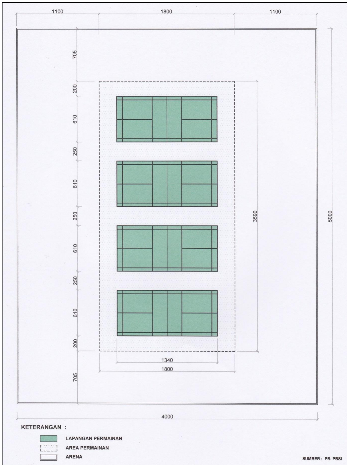
Gambar 3. GOR TIPE A Tata Letak 4 Lapangan Bulu Tangkis untuk Pertandingan Nasional / Internasional
