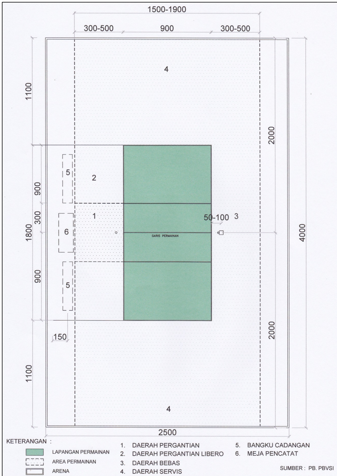
Gambar 13. GOR TIPE B Ukuran Lapangan Voli untuk Pertandingan
