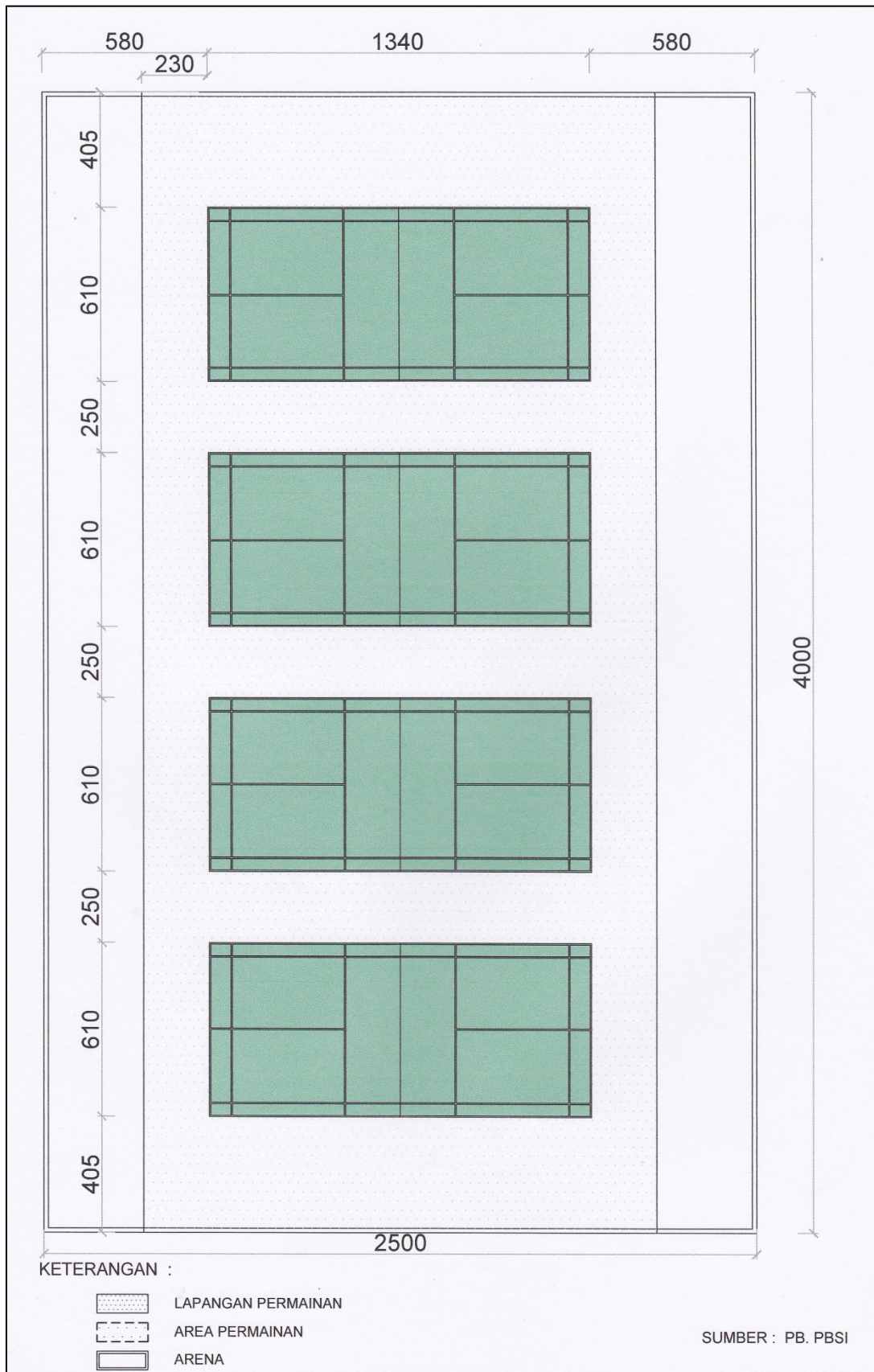
Gambar 12. GOR TIPE B Tata Letak 4 Lapangan Bulu Tangkis untuk Pertandingan
